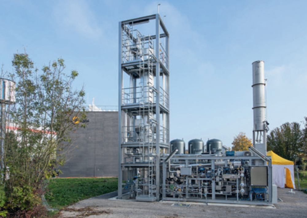
Abb. 2: Als einziger der drei Standorte kommt in der Anlage in Solothurn (Schweiz) die biologische Methanisierung zum Einsatz, bei der Mikroorganismen \text{CO}_2 und \text{H}_2 zu Methan umsetzen.
